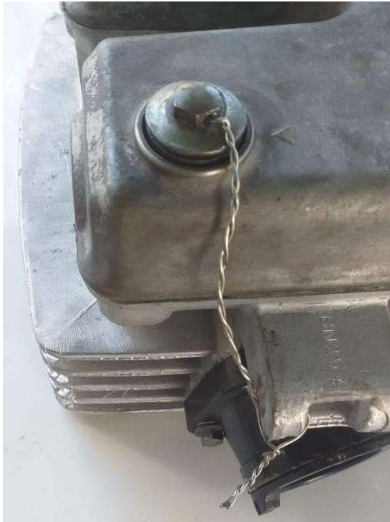
Imagem 3 – Detalhe furo passante no parafuso do cabeçote
