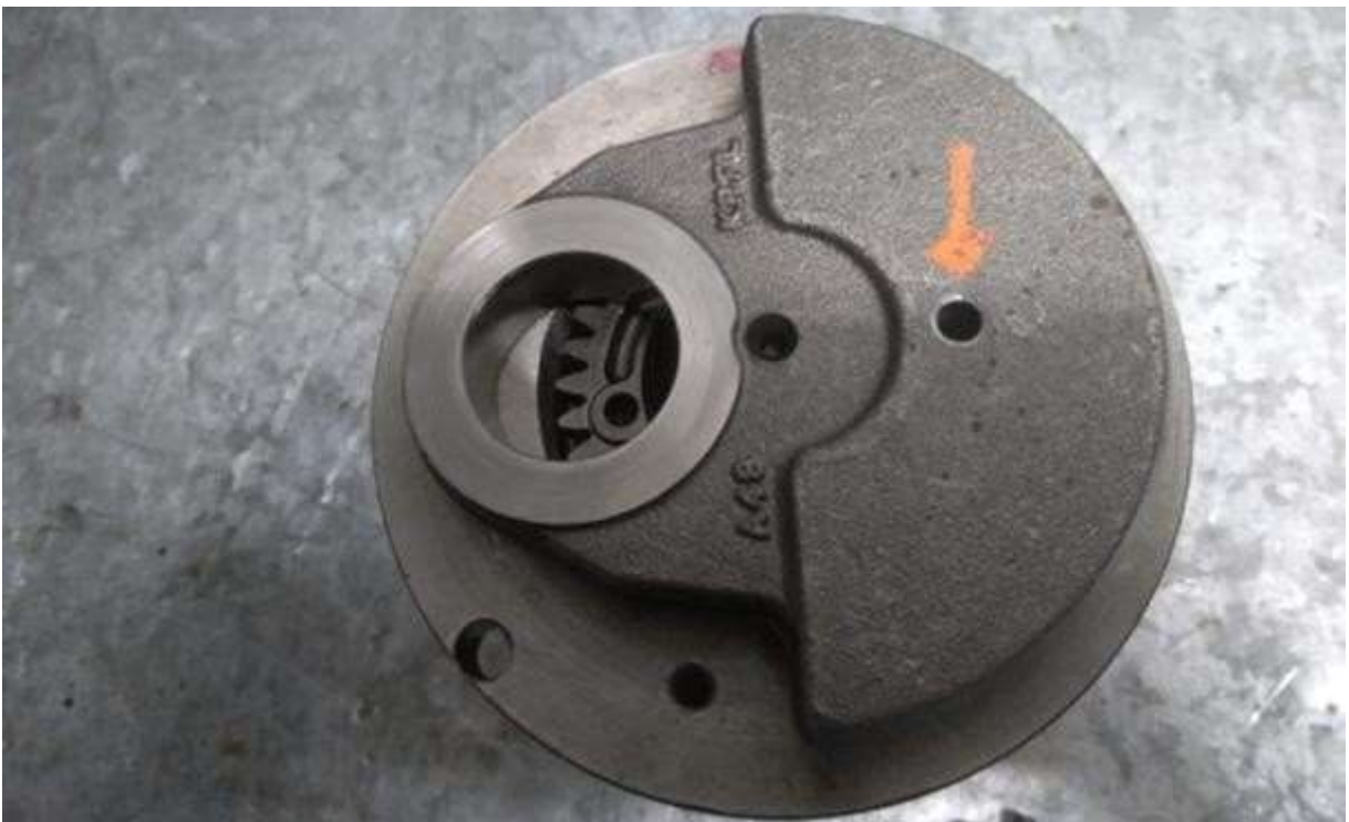
Imagem 5 - detalhe do furo na bolacha do virabrequim
