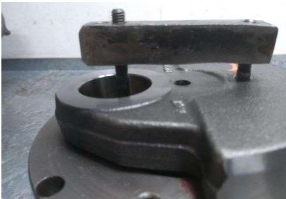
Imagem 7 – detalhe do saque da engrenagem com auxílio do furo e da ferramenta
