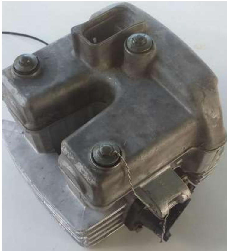
Imagem 2 – Detalhe furo passante no parafuso do cabeçote
